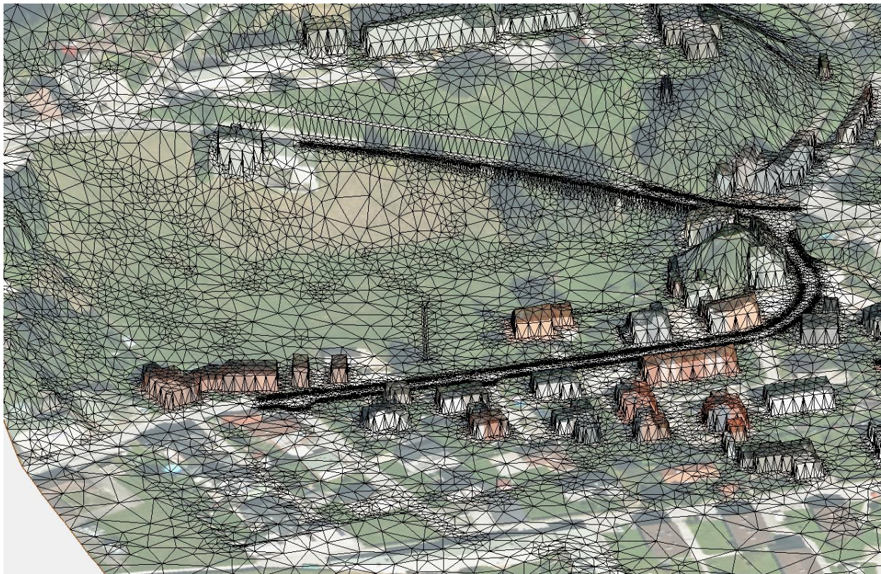
Abbildung 7.2: Abflussmodell Ist-Zustand mit erhöhten Gebäudebereichen
